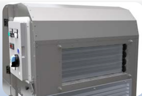
Gitter geschlossen: interne Rückführung der Luft
